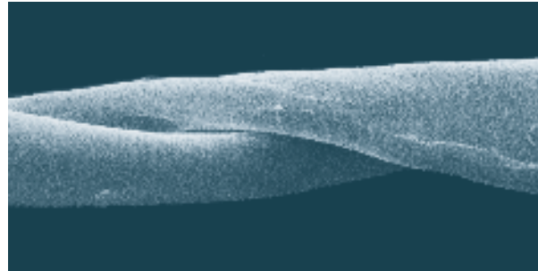
Abbildung: Charakteristisch für Baumwollfasern sind die korkenzieherartigen Windungen, die beim Trocknen der Fasern nach der Trennung vom Samenkern entstehen (REM-Aufnahme Hohenstein Institute).
